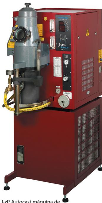
J-zP Autocast máquina de fundición por inducción exhibida en un enfriador de agua
