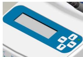
Кнопка **ENTER** (ВВОД) служит для включения и отключения питания и для выбора элементов интерфейса
