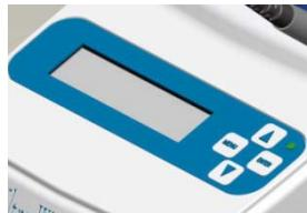
**ENTER-toets** om het apparaat in- en uit te schakelen en om selecties in te voeren
