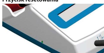
Aby przywrócić ustawienia domyślne urządzenia, należy nacisnąć przycisk resetowania znajdujący się po jego lewej stronie.
